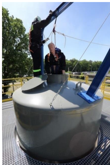
Rys. 16. Trenażer do ewakuacji z przestrzeni zamkniętej - zbiornika
