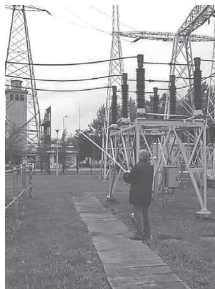
Rys. 6-8. Separacja sondy pomiarowej od osoby mierzącej pole elektryczne małej częstotliwości. a) sonda umieszczona na statywie i połączona z miernikiem światłowodem; b) sonda z miernikiem umieszczona na drążku izolacyjnym (fot. autorzy)
