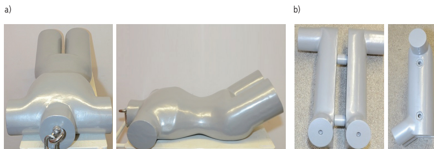
Fot. 2. Manekiny sztywne do badań odporności na obciążenie statyczne uprząży alpinistycznych: a) podstawowa wersja manekina do badania pełnych uprząży typu A i C; b) manekin do badania uprząży typu B o małych rozmiarach
