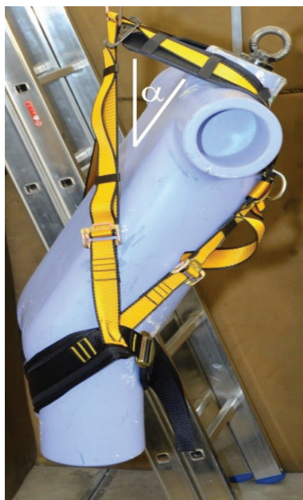
Fot. 5. Manekin sztywny po powstrzymaniu spadania w badaniach zachowania uprząży w warunkach dynamicznych Photo 5. Rigid torso dummy after its fall arrest in a dynamic performance test of a harness
