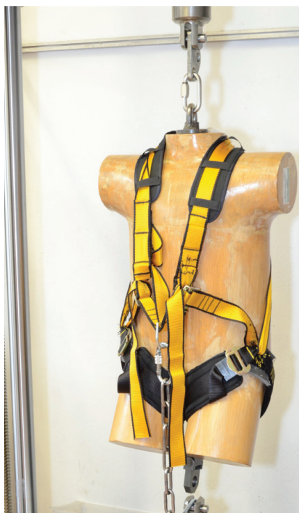
Fot. 1. Badanie odporności na obciążenie statyczne szelek bezpieczeństwa założonych na manekina sztywnym
