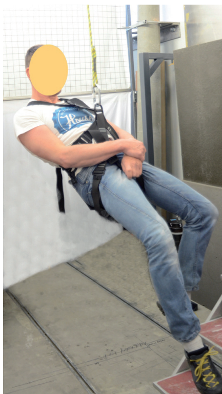
Fot. 6. Zawieszenie uczestnika badań w uprzęży biodrowej Photo 6. Human subject suspended in tested sit harness
