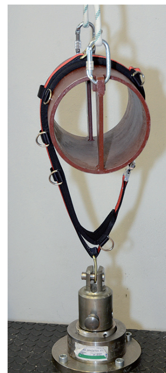
Fot. 3. Badanie odporności na obciążenie statyczne pasa do ustalania pozycji w podparciu, założonego na bęben badawczy
