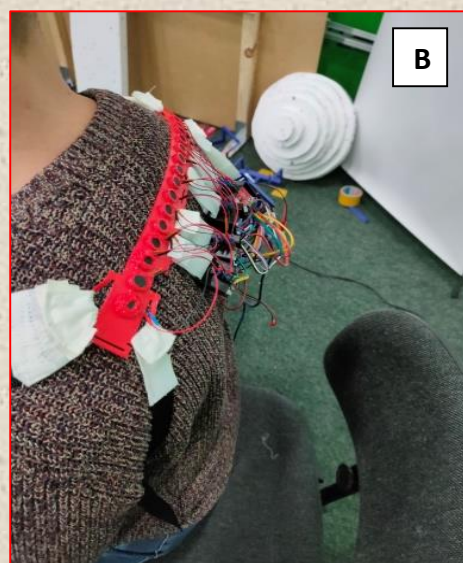
Rys. 1. Podsystem skanujący (A) oraz podsystem wykonawczy (B) wchodzący w skład modelu naręcznego skanera otoczenia
