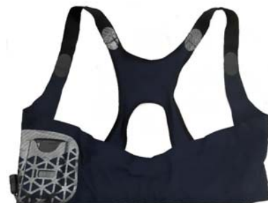
Fot. 4. Kamizelka wraz z nadajnikiem zbierającym dane i zapewniającym bezprzewodową komunikację z programem komputerowym (źródło własne)
