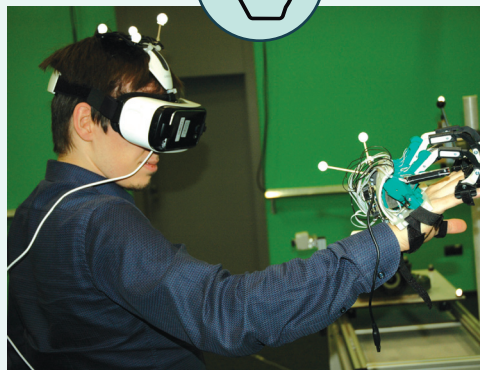
Rękawica VR z siłowym sprzężeniem zwrotnym do symulowania odczucia wrażenia dotyku podczas sterowania wirtualnym urządzeniem lub maszyną
