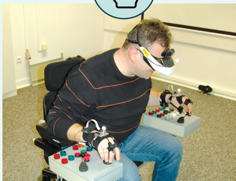
Symulator wirtualnej suwnicy sterowanej za pomocą pulpitu z rzeczywistymi elementami sterowniczymi
