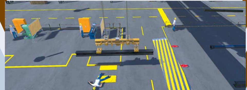
Rys. 3. Widok komputerowo generowanego obrazu ze środowiska – uderzenie pracownika na pasach transportowanym ładunkiem
