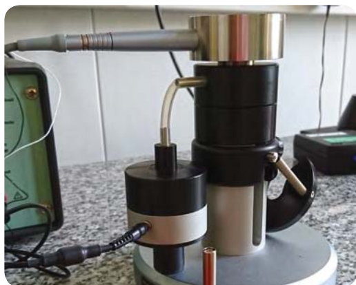
Fot. 2. Wyznaczanie poziomu skuteczności układu symulatora ucha – sposób łączenia symulatora ucha ze sprzęgaczem aktywnym Photo 2. Determination of the sensitivity level of ear simulator system – method of coupling an ear simulator with an active coupler
