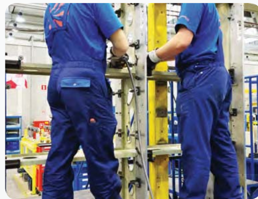
Fot. 1. Nitowanie udarowe nitami zakuwanymi. Fot. WSK PZL-Świdnik S.A.
