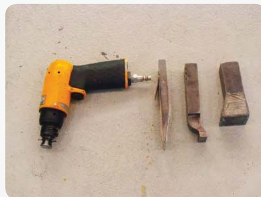
Fot. 2. Młotek pneumatyczny i podtrzymki wolframowe do nitowania udarowego. Fot. WSK PZL-Świdnik S.A.
