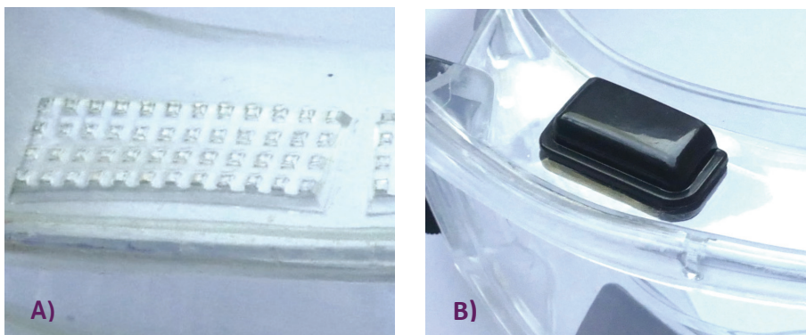
Rys. 14. Sposób wentylacji gogli ochronnych: A) otwory wykonane bezpośrednio na oprawie, B) otwory wentylacyjne minimalizujące dostanie się pyłów lub rozbryzgów cieczy do wnętrza gogli (fot. CIOP-PIB)
