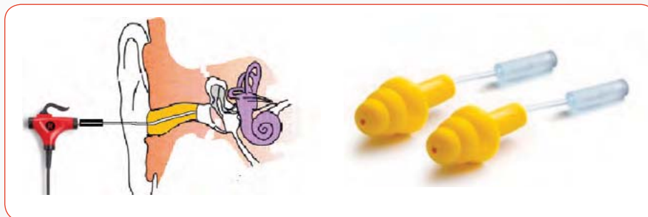
Rys. 2. Schemat sprzężenia sondy mikrofonowej i wkładki przeciwhałasowej umieszczonej w przewodzie słuchowym
