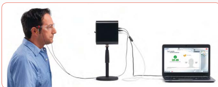
Rys. 1. Schemat podłączenia systemu 3M™ E-A-Rfit™ Dual-Ear Validation
