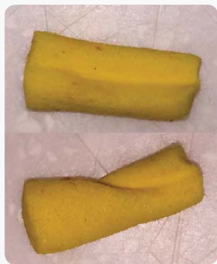
Fot. 2. Przykład źle zrolowanych wkładek przeciwhałasowych
