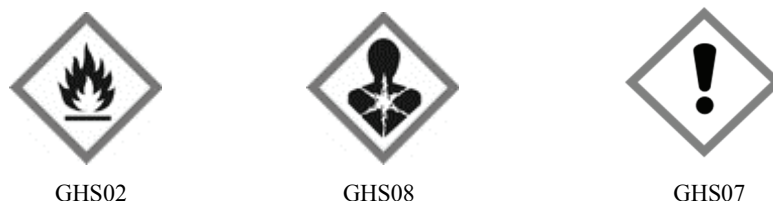
Rys. 1. Kody hasła ostrzegawczego: Niebezpieczeństwo. Piktogramy określone w załączniku do rozporządzenia WE nr 1272/2008 (CLP) mają czarny symbol na białym tle z czerwonym obramowaniem na tyle szerokim, aby było wyraźnie widoczne
