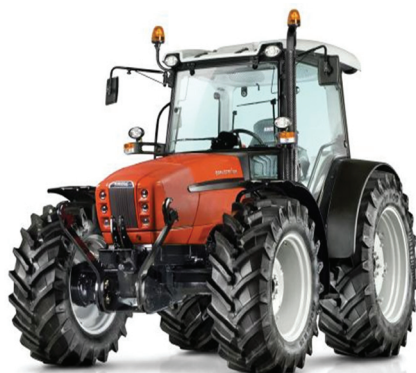
Rysunek 11. Ciągnik Same Explorer z 4-cylindrowym silnikiem SDF serii 1000 mogącym pracować na paliwie B100 i klimatyzowaną kabiną [fot. SDF Group]
