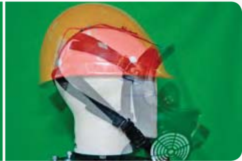
Fot. 7. Nałożone na siebie obrazy prawidłowo założonych na makietę głowy (osobno) hełmu i maski
