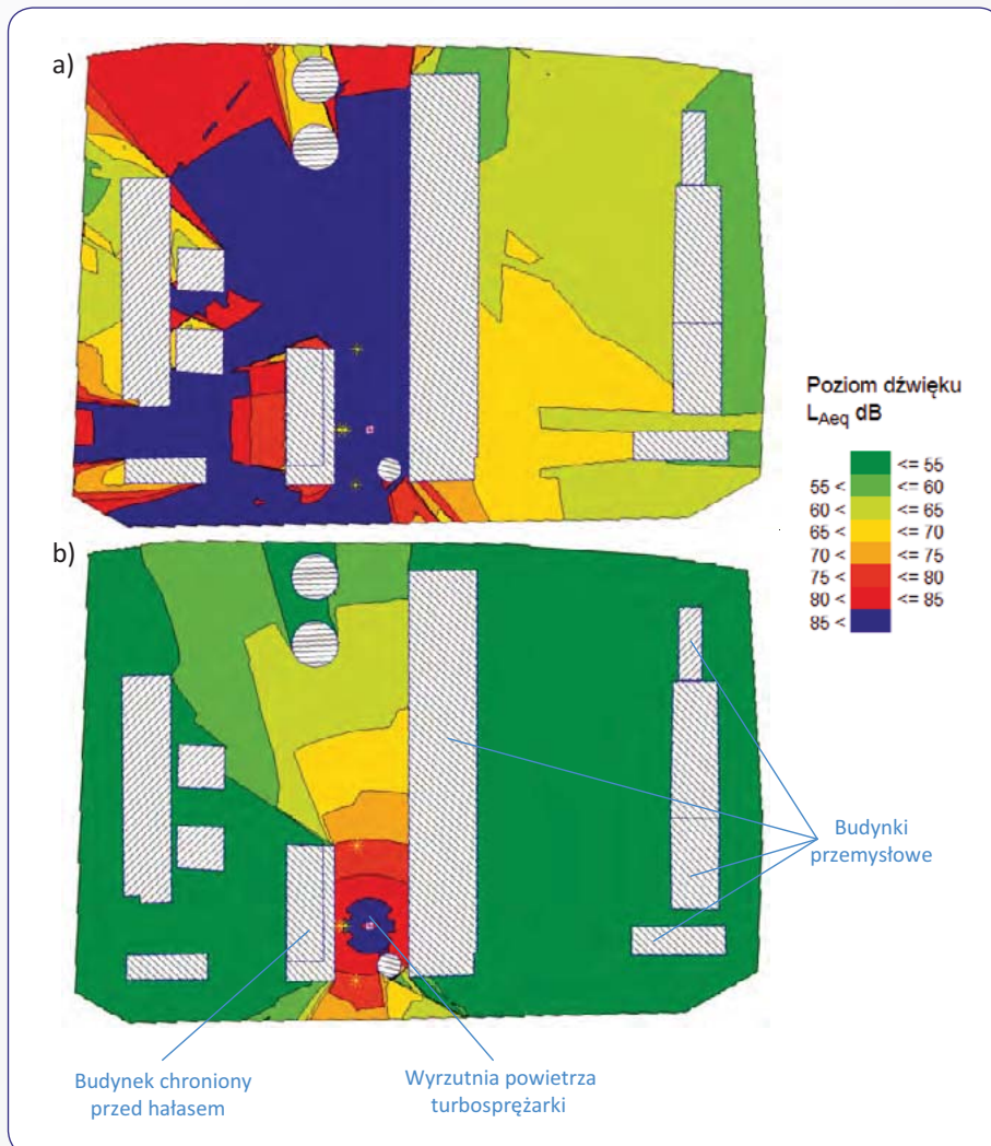
Rys. 5. Rozkład pola akustycznego [7]: a) przed działaniami korygującymi, b) po działaniach korygujących Fig. 5. Spread of acoustic field [7]: a) before correction, b) after correction
