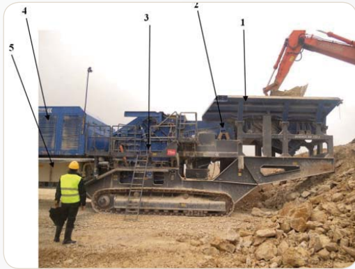
Fot. 5. Kruszarka mobilna podczas pracy w kopalni wapienia Photo 5. Mobile crusher at work in limestone mine
