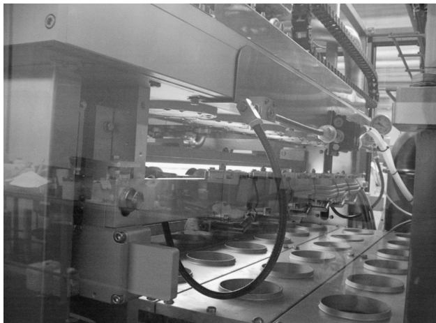
Rys. 1. Widok fragmentu automatu serii 100 z włączonymi promiennikami UV-C
