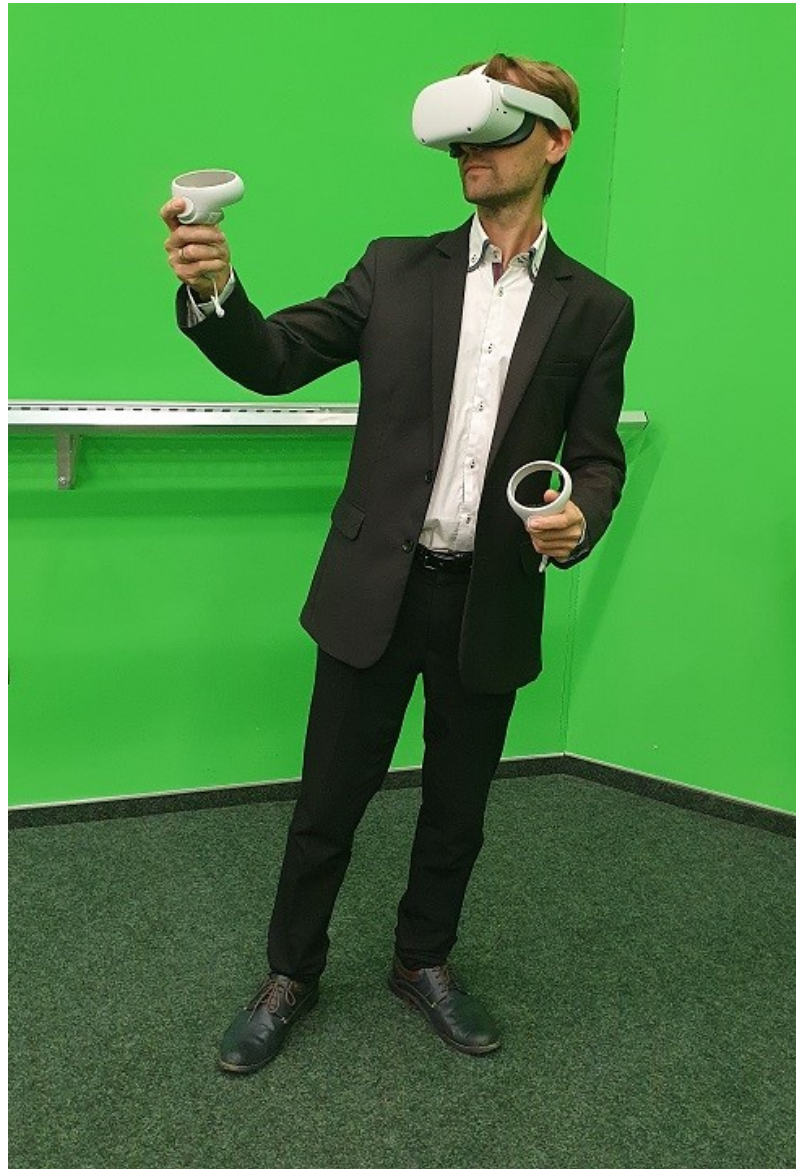
Rys. 1. Gogle rzeczywistości wirtualnej Meta Quest 2 wraz bezprzewodowymi kontrolerami. Gogle umożliwiają bezprzewodowe przesyłanie obrazu środowiska wirtualnego z komputera klasy PC
