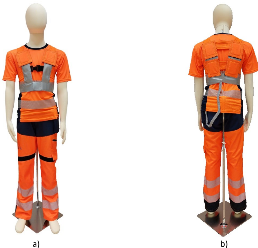
Rysunek 4. Prototyp odzieży ochronnej z funkcją aktywnego chłodzenia wykorzystującej zjawisko termoelektryczne zaprezentowany na manekinie wraz z dedykowaną do stosowania odzieżą ochronną o intensywnej widzialności; a) przód; b) tył
