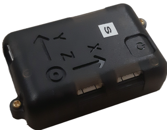
Rysunek 7. Czujnik inercyjny (IMU) stosowany w badaniach z wykorzystaniem systemu przechwytywania ruchów ciała
