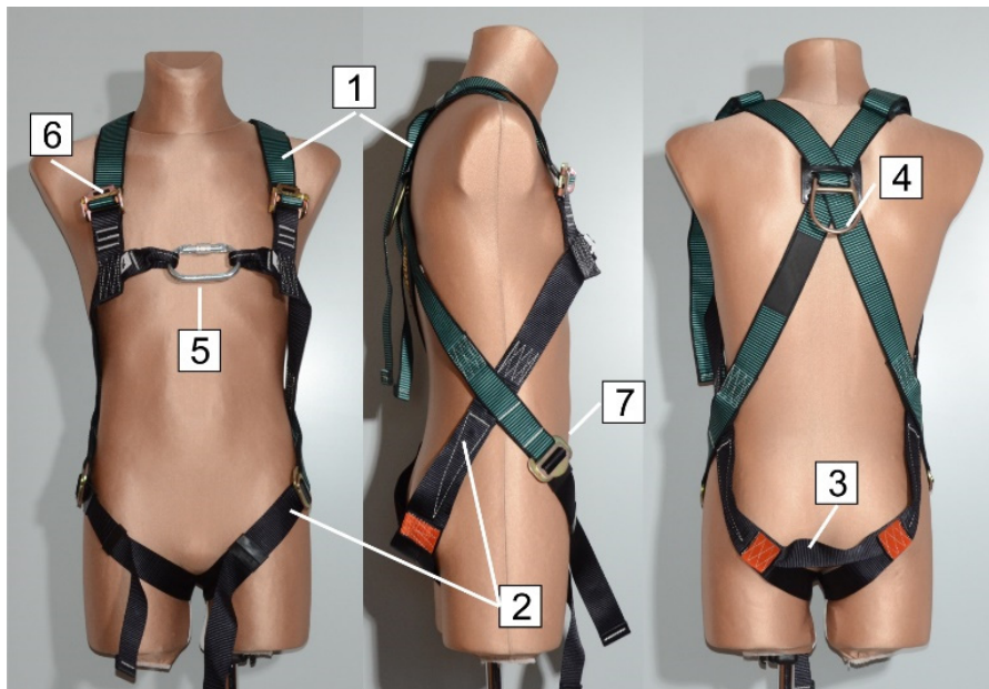
Rys. 1. Szelki bezpieczeństwa z krzyżującymi się na biodrach pasami barkowymi i udowymi: 1 – pasy barkowe, 2 – pasy udowe, 3 – siodełko, 4 – tylna klamra zaczepowa, 5 – przednia klamra zaczepowa, 6 – klamra regulacyjna pasa barkowego, 7 – klamra spinająco-regulacyjna pasa udowego (źródło: autor)
