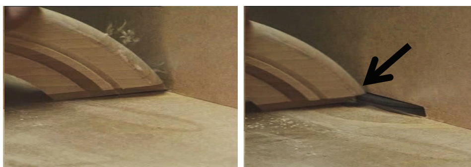
Rys. 4. Przykład ostony freza wykonanej specjalnie do określonego rodzaju frezowania
