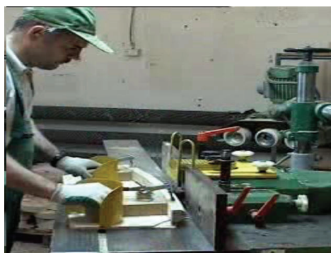
Rys. 5. Przykład przyrządu obróbkowego do mocowania i prowadzenia materiału podczas frezowania (prosto- lub krzywoliniowego)
