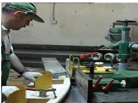
Rys. 5. Przykład przyrządu obróbkowego do mocowania i prowadzenia materiału podczas frezowania (prosto- lub krzywoliniowego)
