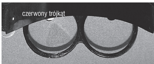
Rys. 10.13. Sygnał AR w postaci czerwonego trójkąta
