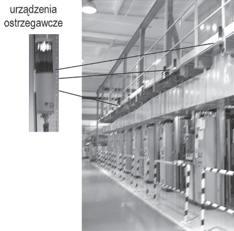
Rys. 10.1. Przykład urządzeń ostrzegających o uruchomieniu zautomatyzowanej linii produkcyjnej
