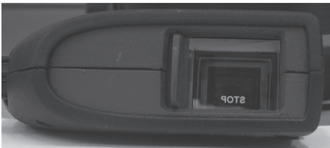
Rys. 10.6. Sygnał alfanumeryczny STOP widoczny od zewnętrznej strony okularu LITEYE-500
