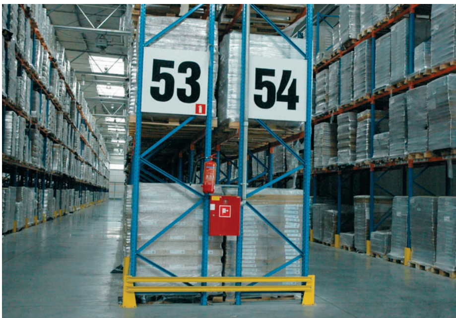
Rys. 14. Widok ogólny regałów paletowych rzędowych
