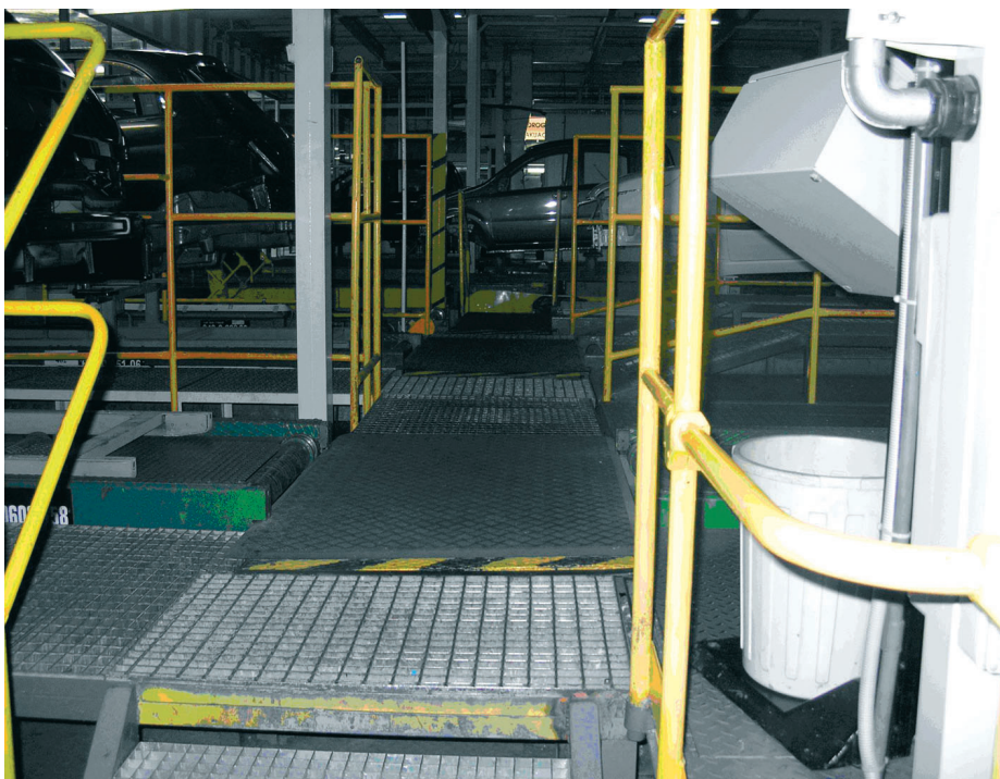
Rys. 7. Zastosowanie urządzeń ochronnych na skrzyżowaniu dróg transportowych
