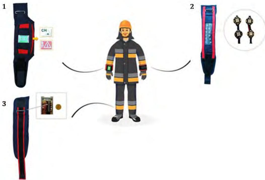
Projekt III.N.16. Schemat przedstawiający opracowane systemy sygnalizacji zagrożeń i ich rozmieszczenie na odzieży ochronnej, gdzie: 1 – SSZ z wyświetlaczem LCD, 2 – SSZ z diodami LED, 3 – SSZ z elementem wibracyjnym
