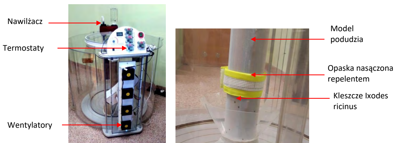
Zadanie 3.G.07. Stanowisko do badania skuteczności odstrasżania kleszczy przez materiały odzieżowe zawierające repelenty
