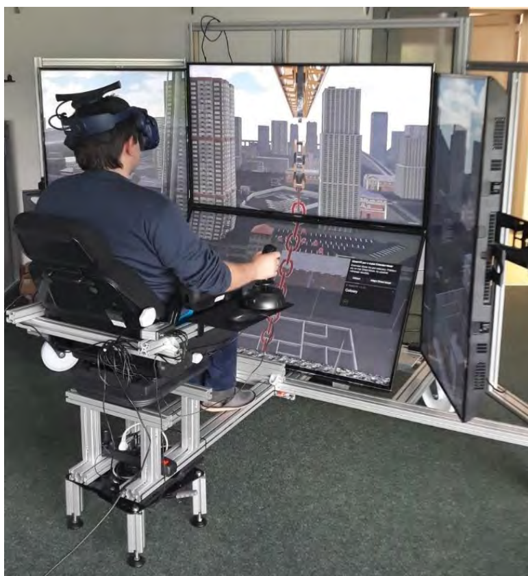
Zadanie 4.G.27. Laboratoryjna wersja symulatora żurawia wieżowego opracowana w ramach opisywanego zadania
