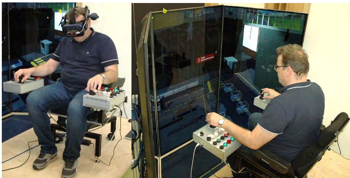
Zadanie 4.G.28. Widok symulatora suwnicy pomostowej sterowanej z poziomu kabiny w wersji przenośnej (a) i stacjonarnej (b)
