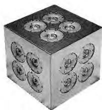
Zadanie 3.G.02. Laboratoryjne źródło dźwięku w zakresie częstotliwości 10–40 kHz
