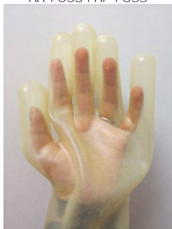
Rękawica z kauczuku metylwinylosilikonowego z zaimplementowanymi silseskwioksanami: AA-POSS i AP-POSS
