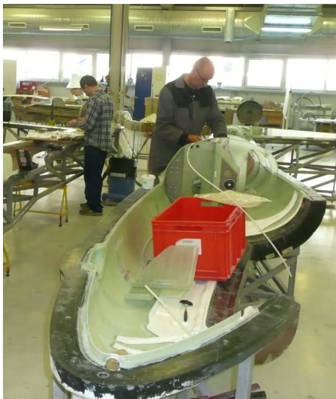
Zadanie 2.G.11. Proces łączenia materiałów realizowany w przedsiębiorstwie przemysłu lotniczego przy użyciu technologii klejenia. Obok ekran startowy aplikacji mobilnej dla przemysłu lotniczego
