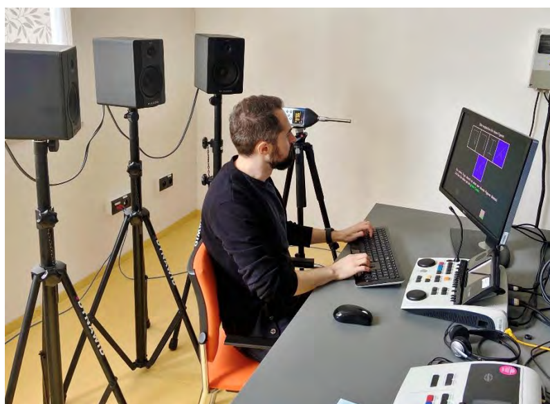
Zadanie 1.G.06. Stanowisko do badań uciążliwości hałasu tonalnego
