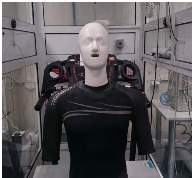
Zadanie 3.G.11. Zrobotyzowany model głowy i tułowia wewnątrz komory do badania całkowitego przecieku wewnętrznego
