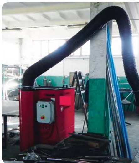
Fot. 4. Przykładowe instalacje odpylające i urządzenia filtracyjne stosowane w procesach spawania Photo. 4. Examples of dust removal installations and filtration devices in a process enclosure
