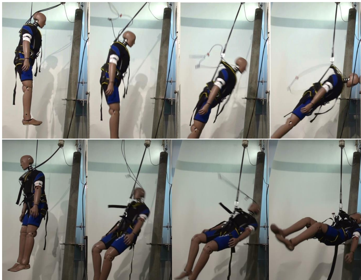
Rys. 6. Przykłady ruchu wahadłowego podczas powstrzymywania spadania zakończonego zderzeniem z płaską przeszkodą
