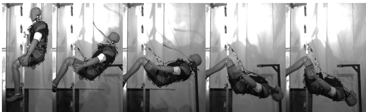
Rys. 3. Niebezpieczny sposób powstrzymywania spadania z wysokości przez urządzenie samozaciskowe ze sztywną prowadnicą połączone z niewłaściwie dobranymi szelkami bezpieczeństwa
