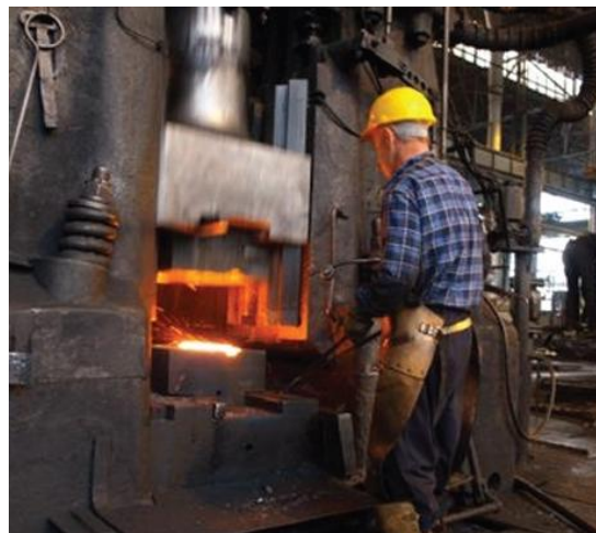
Rys. 3. Stanowisko w kuźni przemysłowej matrycowej 1
