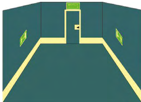
Rys. 3-7. Przykład dodatkowego oznakowania drogi ewakuacyjnej za pomocą pasów z materiału fosforescencyjnego umieszczonych na ścianach wzdłuż podłogi [18]
