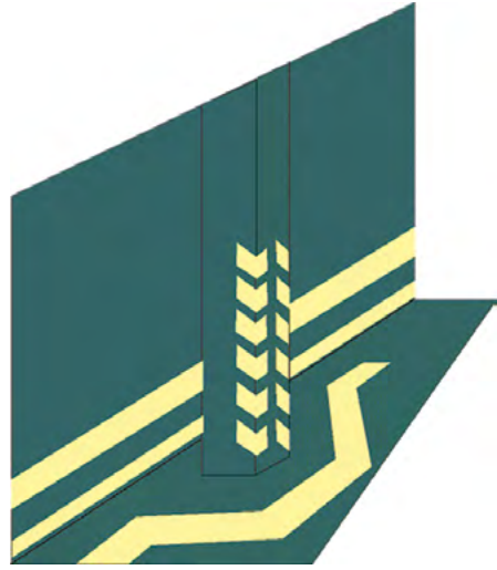
Rys. 3-12. Przykład oznakowania przeszkód na drodze ewakuacyjnej [18]
