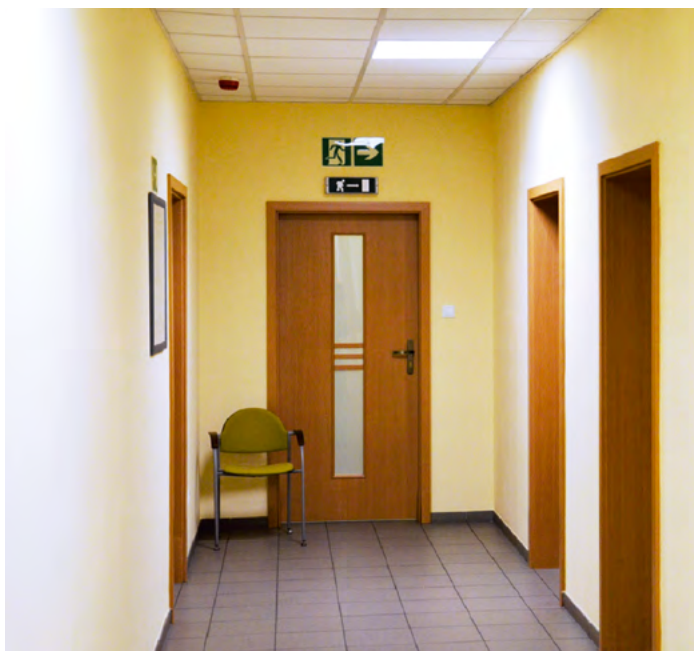
Rys. 2-48. Kontrastowe barwy płaszczyzn ścian, posadzki i drzwi do pomieszczeń (źródło: CIOP-PIB)
