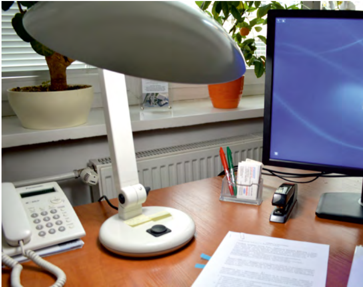
Rys. 2-50. Przykład miejscowego oświetlenia stanowiska pracy (źródło: CIOP-PIB)
