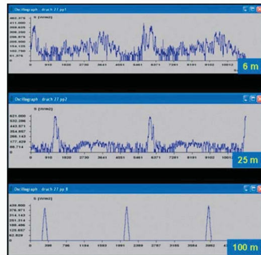
Rys. 2. Wartości chwilowe natężenia pola elektrycznego w pionach pomiarowych umieszczonych w odległościach 6, 25 i 100 m od anteny odległościomierza
