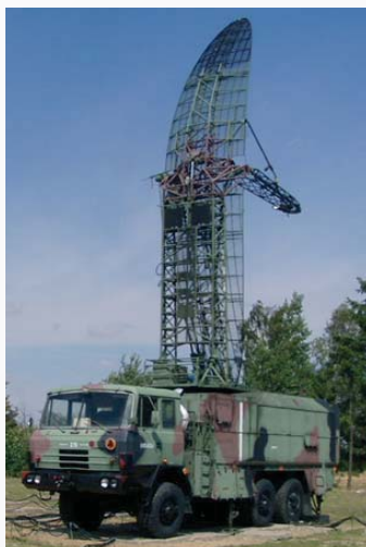
Rys. 2. Widok ogólny wysokościomierza Fig. 2. An overview of height finder radar
