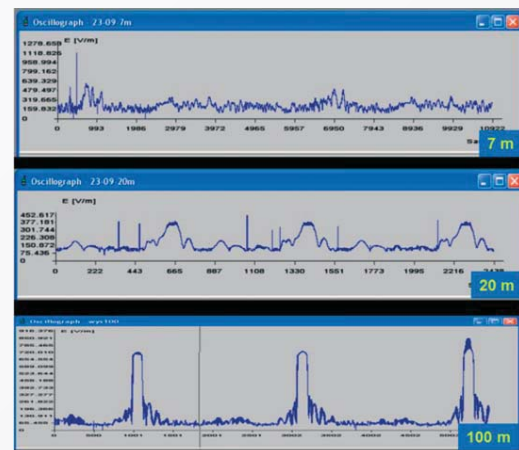
Rys. 3. Wartości chwilowe natężenia pola elektrycznego w pionach pomiarowych umieszczonych w odległościach 7, 20 i 100 m od osi anteny wysokościomierza
