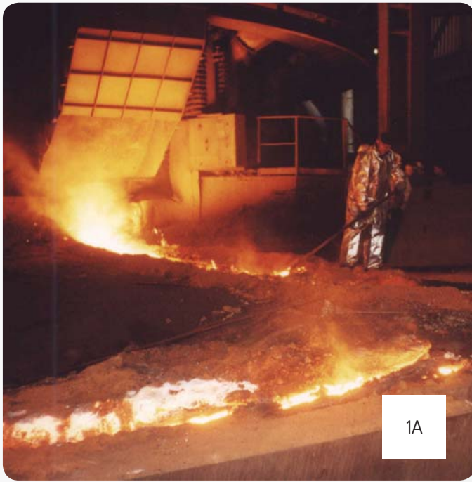
Fot. 1. Spust surówki z wielkiego pieca; pierwszy garowy, w kombinezonie z materiału metalizowanego, wykonuje typowe czynności podczas spustu surówki; temperatura surówki wynosi 1430-1480 °C, 1A – z bliższej i 1B – z dalszej perspektywy (źródło własne)
