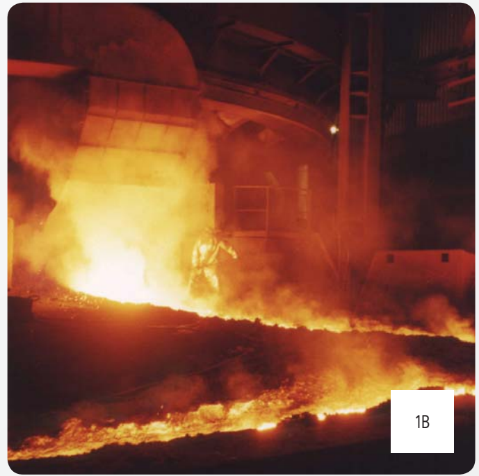
Fot. 1. Spust surówki z wielkiego pieca; pierwszy garowy, w kombinezonie z materiału metalizowanego, wykonuje typowe czynności podczas spustu surówki; temperatura surówki wynosi 1430-1480 °C, 1A – z bliższej i 1B – z dalszej perspektywy (źródło własne)
